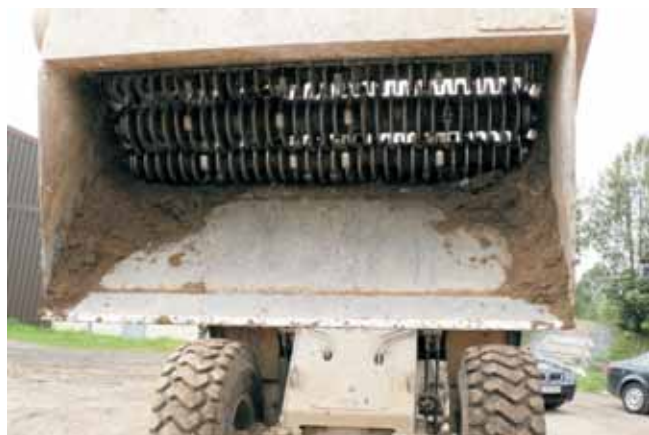
1. Łyżka przesiewająco-krusząca z modulem dozującym.
