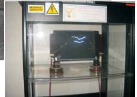
Stanowisko do demonstracji wyładowania.
