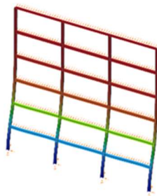
współczynnik \alpha_{cr,sw} = 9,46 wyboczenie w płaszczyźnie układu
