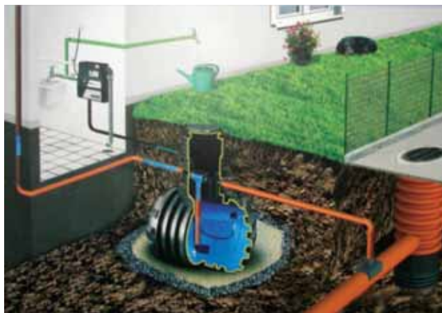
Rys. 12. Przykładowe rozwiązanie gospodarstwa domowego wykorzystującego wody atmosferyczne na różne cele w małym domu mieszkalnym
