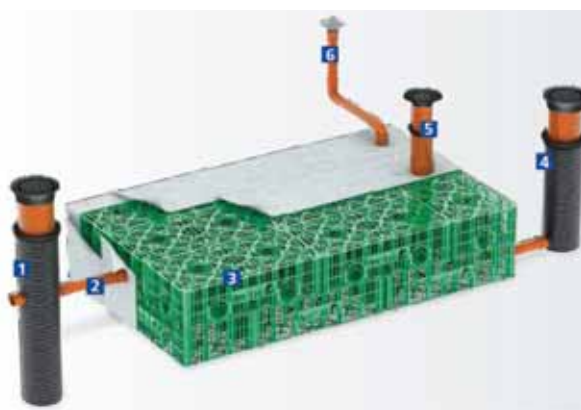
Rys. 13. Przykład zbiornika retencyjnego STORMBOX wraz z jego oznaczeniami
