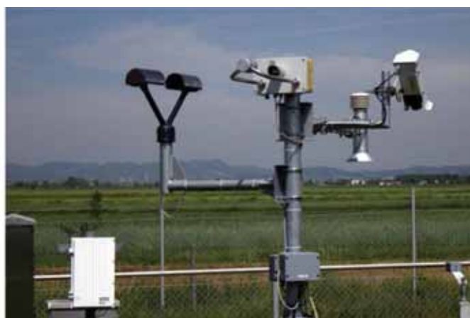
Fot. 5. Disdrometr hydrometryczny Parsivel firmy OTT Messtechnik, disdrometr firmy ThiesClima, wskaźnik laserowy SHM30 wysokości śniegu firmy Jenoptik, ultradźwiękowy miernik wysokość pokrywy śnieżnej USH-8
