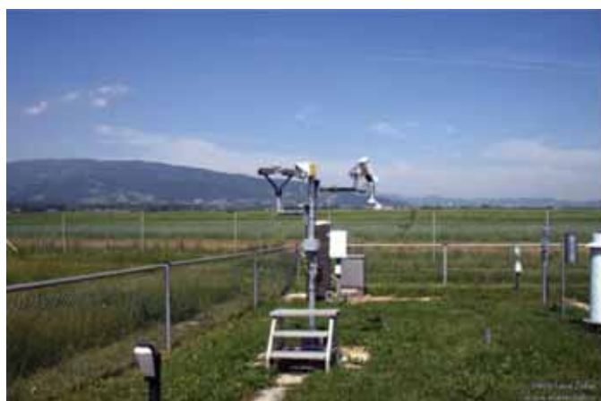
Fot. 4. Przykładowy ogólny widok stacji meteorologicznej z różnymi urządzeniami (disdrometr hydrometryczny, disdrometr klimatyczny, wskaźnik laserowy, ultradźwiękowy miernik pokrywy śnieżnej)
