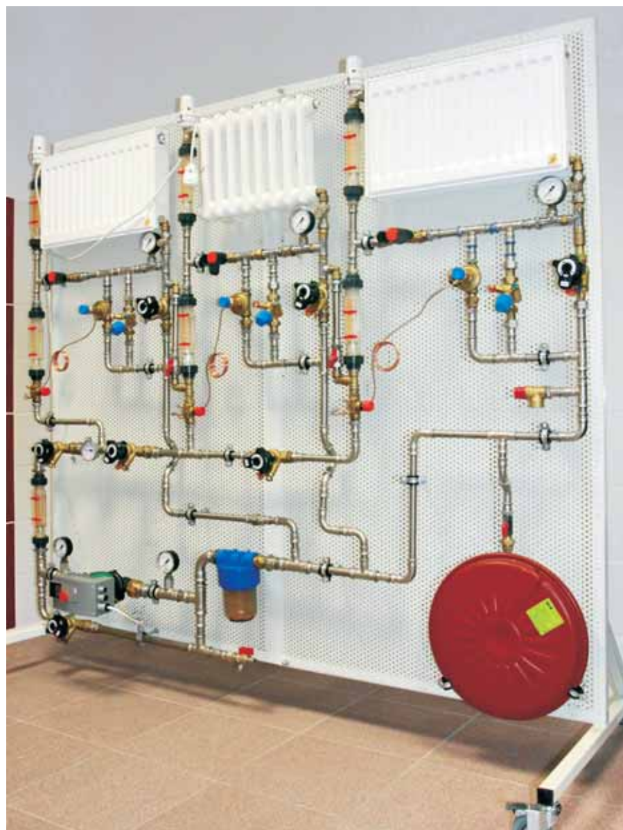
Stanowisko do badania hydraulicznego równoważenia instalacji grzewczych
