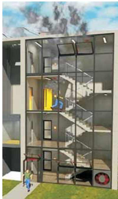
Rys. 2. Systemy grawitacyjnego oddymiania pionowych dróg ewakuacyjnych
