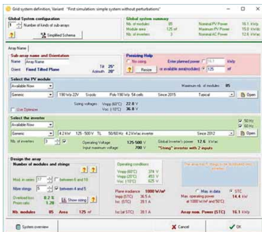
Rys. 5. Okno główne programu PVSyst z możliwością projektowania instalacji PV
