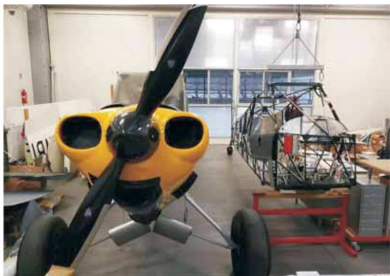
Zmontowany kadłub samolotu Carbon Cub, a obok kratownica kadłuba następnego takiego samolotu
