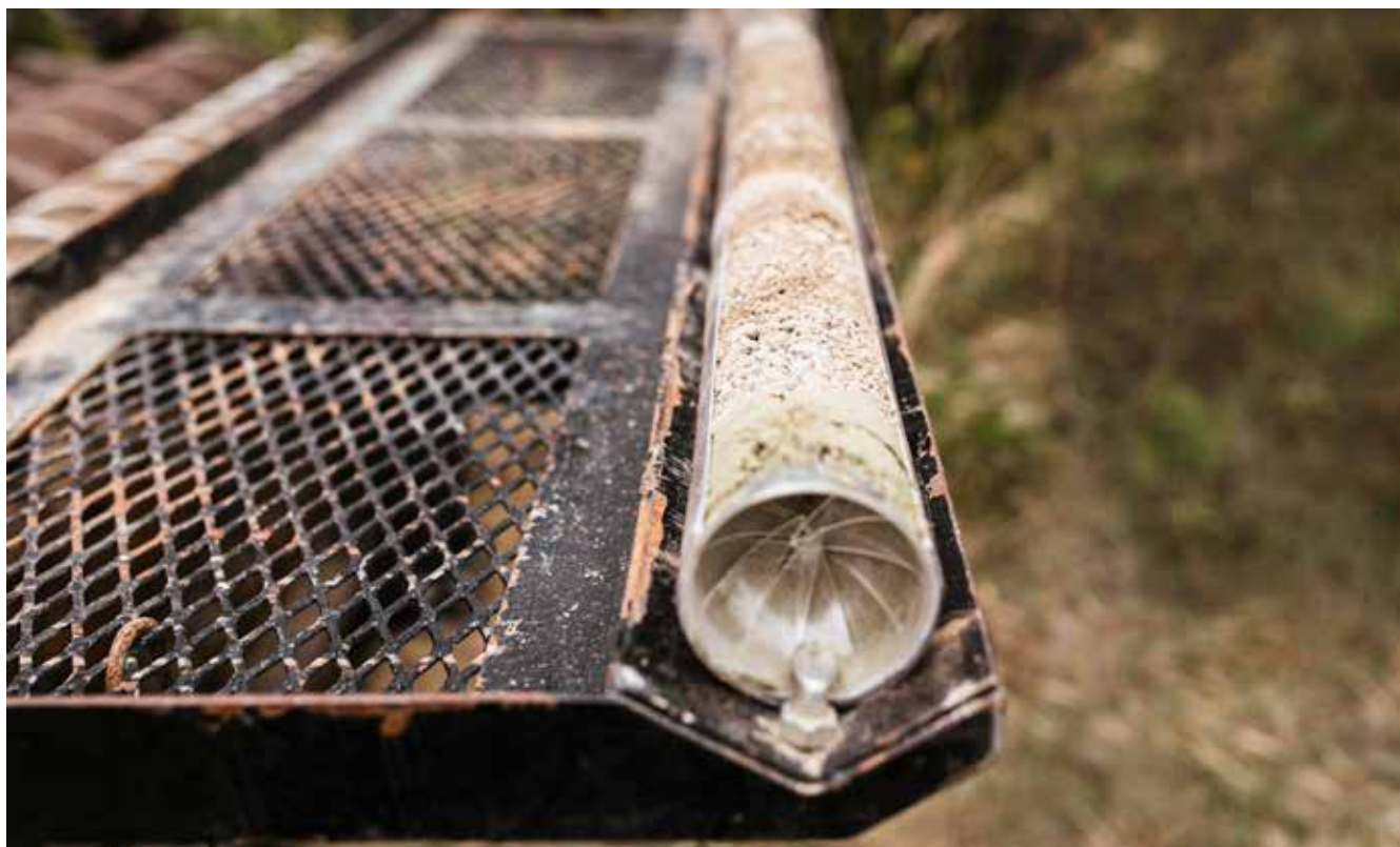
Materiał do badań pobrany korzystając z technologii direct push
