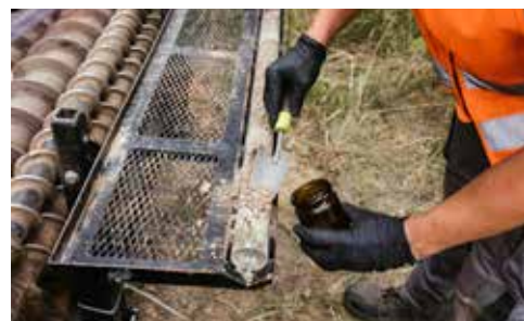
Pobieranie próbek gruntu metodą direct-push
